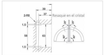
Bisagra muro - vidrio, doble acción, para 25 Kg. Fijación a muro. Para puertas de cristal templado de 8 a 12 mm.
