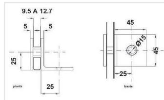
Clip para vidrio fijo a 90° se fija a muro. Para vidrio templado de 10 a 12 mm. El vidrio requiere perforación.
