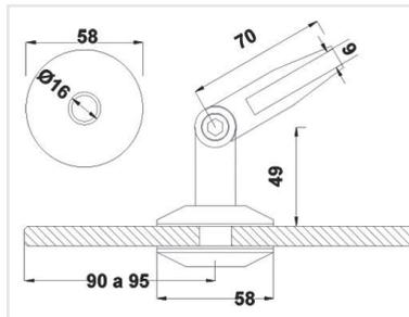
Conector vidrio-tensor para marquesina. El vidrio requiere perforación para su fijación.
