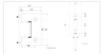
Bisagra cuadrada sin bisel muro-vidrio, doble acción, para 25kg. El cristal necesita resaque para su fijación. Para puertas de cristal templado de 8-12mm.
