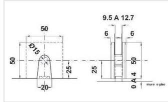
Clip biselado para vidrio fijo con resaque. Para vidrio templado de 10 a 12 mm.
