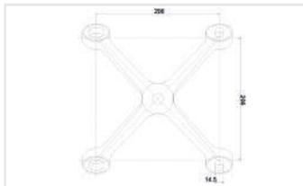
Araña de 4 patas a 90°. Instalación a viga Para fijación a 4 cristales.
