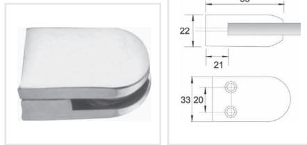
Conector grapa base plana para vidrio de 6 a 8 mm. No requiere perforación en el vidrio.
