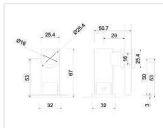
Conector muro-vidrio 90° con chapetón. Para vidrio de 8 a 12 mm.
