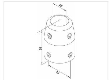
Conector para barra de 1" con fijación a muro.
