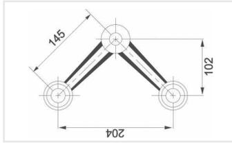
Araña de 2 patas para instalación a viga con fijación a 2 vidrios.
