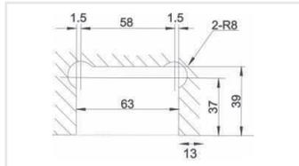
Bisagra de vibel doble acción, para 30 Kg. Fijación a piso y techo. Para puertas de cristal templado de 8 a 12 mm.
