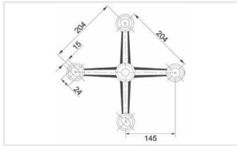
Araña de 4 patas para instalación a viga con fijación a 4 vidrios.
