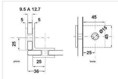
Clip vidrio-vidrio a 90°. Para vidrio templado de 10 a 12 mm. El vidrio requiere perforación.
