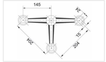
Araña de 3 patas para instalación a viga con fijación a 3 vidrios.
