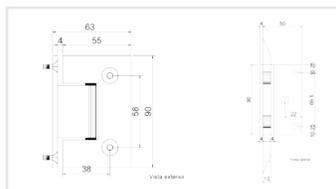
Bisagra cuadrada sin bisel muro-vidrio, desfasada doble acción, para 25 kg. El cristal necesita resaque para su fijación. Para puertas de cristal templado de 8 a 12 mm.
