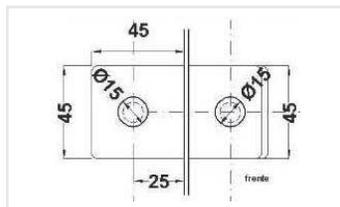
Clip vidrio-vidrio a 135°. Para vidrio templado de 10 a 12 mm. El vidrio requiere perforación.
