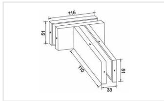
Herraje superior rectangular con portacostilla para sujetar 2 vidrios fijos a 180°
