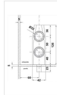
Pivote de giro superior, se fija a un antepecho de vidrio. Se requieren 2 perforaciones con avellanado.
