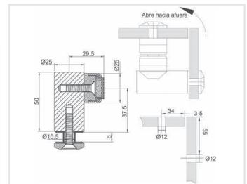
Tope para puerta con imán. Fijación al vidrio. Se necesita perforación de 12 mm.
