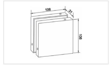
Conector para sujeción de 4 vidrios para fachada; sin porta costilla.
