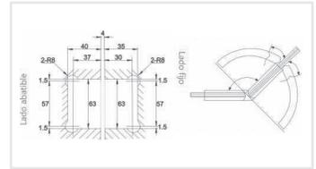
Bisagra vidrio - vidrio a 135°. Doble acción, para 25 Kg. Para puertas de cristal templado de 8 a 12 mm.
