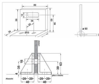
Ángulo de sujeción para vidrios fijos de 10-19 mm.
