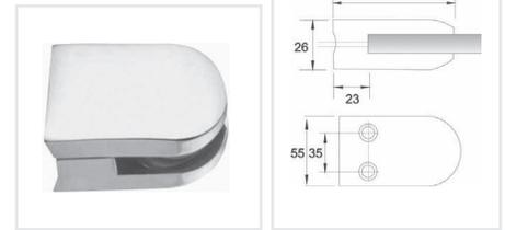
Conector grapa base curva para vidrio de 8 a 10 mm. No requiere perforación en el vidrio.
