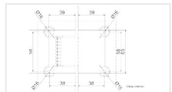
Bisagra cuadrada sin bisel vidrio-vidrio a180°, doble acción, para 25 kg. El cristal necesita resaque para su fijación. Para puertas de cristal templado de 8 a 12 mm.
