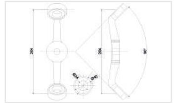
Araña de 2 patas a 90°. Instalación a viga Para fijación a 2 cristales
