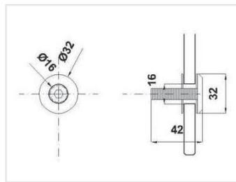
Chapetón para herrajes 1200. Útil para cambiar el avellanado por perforación a corte recto, si así se requiere.
