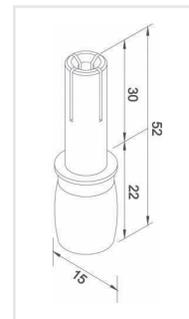
Pivote de giro para herraje superior. Fijación a techo para taquete expansivo.
