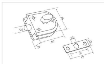
Seguro biselado sin llave con contra a muro. El vidrio necesita resaque para su fijación.
