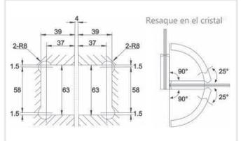
Bisagra vidrio - vidrio a 90°. Doble acción, para 25 Kg. Para puertas de cristal templado de 8 mm.
