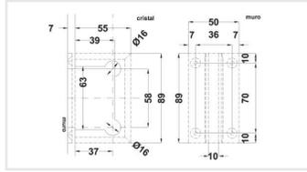
Bisagra muro-vidrio, doble acción, para 25 kg. El cristal necesita resaque para su fijación. Para puertas de cristal templado de 8 a 12 mm.
