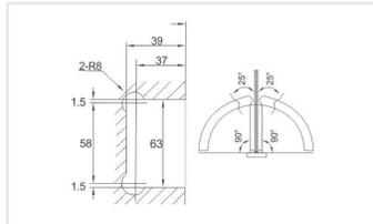
Bisagra muro - vidrio, desfasada doble acción, para 25 Kg. Para puertas de cristal templado de 8 a 12 mm.
