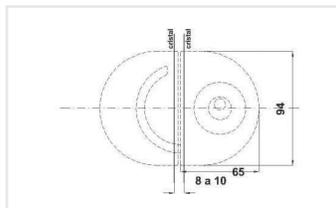
Chapa de gancho con contra a vidrio. Entrada de llave sólo por un frente. El vidrio no necesita resaque para su fijación. Puerta abatible y/o corrediza.
