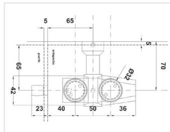
Pivote de giro superior y antepecho con fijación a muro. Se requieren 2 perforaciones con avellanado. Adaptable de Izquierda a Derecha.
