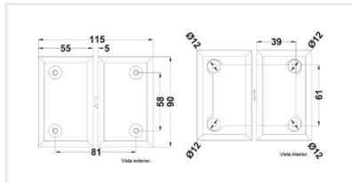
Bisagra videl doble acción, Fijación a entrepaño de vidrio. Para puertas de cristal templado de 8 a 12 mm.
