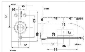
Pivote de giro para herraje inferior. Fijación a piso.
