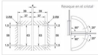
Bisagra vidrio - vidrio a 90°. Doble acción, para 25 Kg. Para puertas de cristal templado de 8 a 10 mm.
