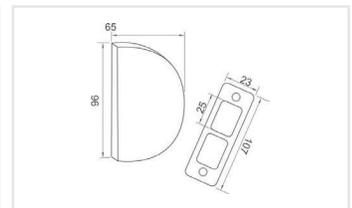
Chapa de gancho con contra a muro. El vidrio no necesita resaque para su fijación.
