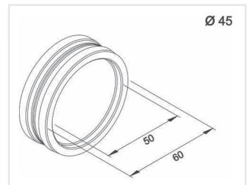
Jaladera para puerta de vidrio templado en sistema corredizo. Se necesita perforación de 15 mm.
