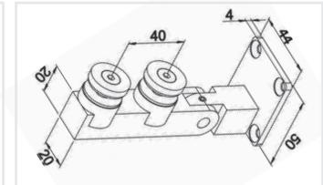
Bisagra muro-vidrio soporte cuadrado. Fijación a muro. Para 25 Kg. Para vidrio templado de 8 a 12 mm.
