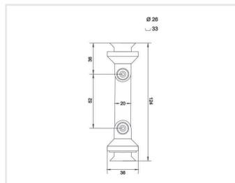
Conector vidrio-vidrio para barandal o vidrio fijo con ángulo ajustable. Para vidrio de 8 a 12 mm.
