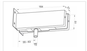
Herraje superior con pivote para antepecho. Fijación a muro con placa.
