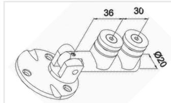
Bisagra muro-vidrio soporte redondo. Fijación a muro. Para 15 Kg. Para vidrio templado de 8 a 12 mm.
