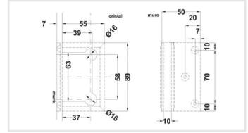
Bisagra muro-vidrio, desfasada doble acción, para 25 kg. El cristal necesita resaque para su fijación. Para puertas de cristal templado de 8 a 12 mm.
