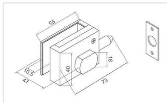
Seguro sin llave con contra a muro. No necesita resaque para su instalación.
