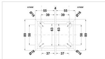
Bisagra vidrio-vidrio a180°, doble acción, para 25 kg. El cristal necesita resaque para su fijación. Para puertas de cristal templado de 8 a 12 mm.
