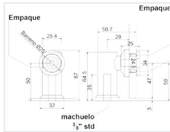
Conector para vidrio de 8 a 12 mm. Muro-vidrio 90°. Incluye tornillo con taquete expandible.
