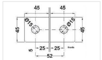
Clip vidrio-vidrio a 180°. Para vidrio templado de 10 a 12 mm. El vidrio requiere perforación.
