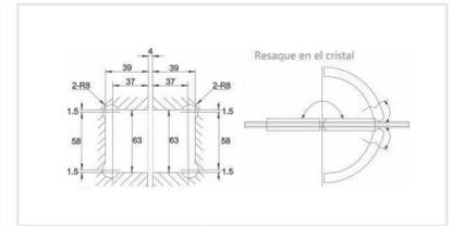
Bisagra vidrio - vidrio a 180°. Doble acción, para 25 Kg. Para puertas de cristal templado de 8 a 12 mm.
