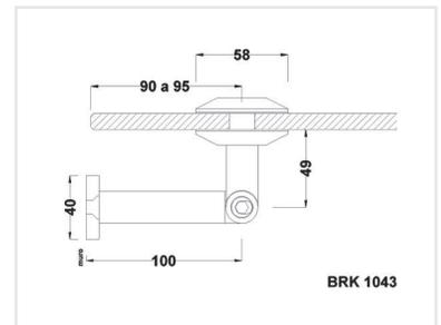
Conector muro-vidrio para marquesina. El vidrio requiere perforación para su fijación.
