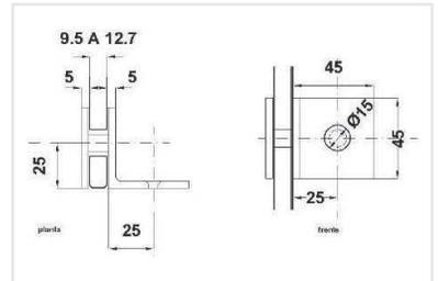
Clip para vidrio fijo a 90° a muro. Para vidrio templado de 10 a 12 mm. El vidrio requiere perforación.
