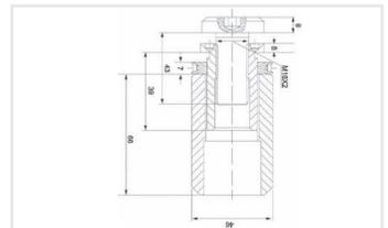
Conector soldable a estructura metálica plana o curva.
