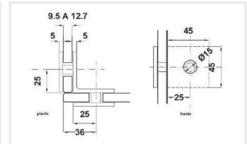
Clip vidrio-vidrio a 90°. Para vidrio templado de 10 a 12 mm. El vidrio requiere perforación.
